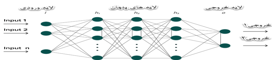
شکل ۲: ساختار شبکه عصبی عمیق مدل پیشنهادی
